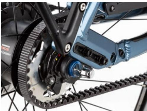
Schraubachse an einer Nabenschaltung.
