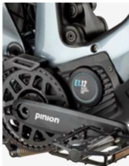
Neben weit verbreiteten Antrieben von Bosch oder SHIMANO gibt es mittlerweile moderne Mittelmotoren von Pinion mit integrierter Schaltung.
