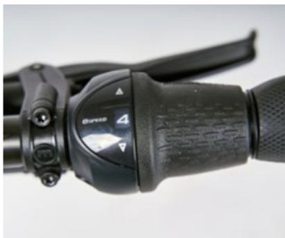
Häufig werden Nabenschaltungen mit praktischen Drehschaltgriffen kombiniert.
