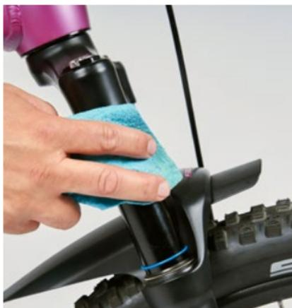
Die Standrohre der Federgabel und der Kolben des Hinterbaudämpfers müssen stets sauber und gepflegt sein. Nur so sind Fahrspaß und Sicherheit, auch im groben Gelände, garantiert.
