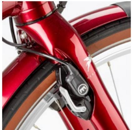
Hydraulische Felgenbremsen sind für hochwertige City- und Touren-Bikes ein hervorragender Kompromiss in Sachen Sicherheit und geringem Wartungsaufwand.
