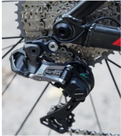
Elektronisches Schaltwerk der SHIMANO GRX-Schaltung fürs Gravelbike.
