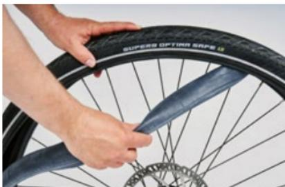
Anschließend den defekten Schlauch vorsichtig entfernen. Dabei darauf achten, dass keine Fremdkörper im Reifeninneren oder der Felge verbleiben.
