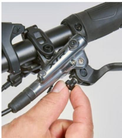
Diese kleine Schraube hat keinen Einfluss auf die Bremswirkung; hier kann der Abstand des Bremshebels zum Lenkergriff verändert werden.
