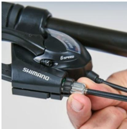
Durch das Herausschrauben der Einstellschraube lässt sich die Zugspannung bei Seilzugbremsen erhöhen.
