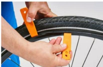
Nach dem Ausbau des Laufrades wird mittels geeigneten Reifenhebern der Mantel angehoben.
