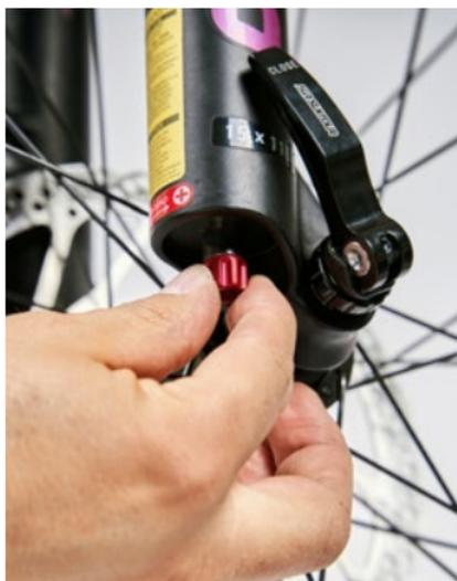
Das Drehrädchen an der Unterseite der Federgabel regelt meist die Zugstufe – also die Ausfederungsgeschwindigkeit.
