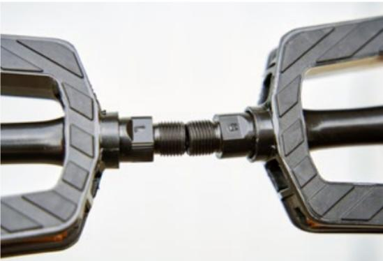
Vorsicht beim Einschrauben von Pedalen: Das linke Pedal hat ein Linksgewinde, das rechte ein Rechtsgewinde.
