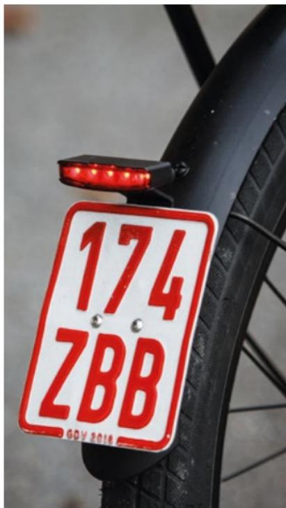
Haupterkennungsmerkmal eines S-Pedelecs ist neben dem markanten Rückspiegel ein Versicherungskennzeichen wie am Mofa.
