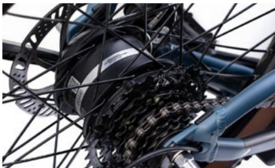
Heck-Nabenmotoren sind inzwischen Exoten, etwa an sportlicheren Modellen, sehr leichten E-Bikes oder S-Pedelecs, die bis 45 km/h unterstützen.
