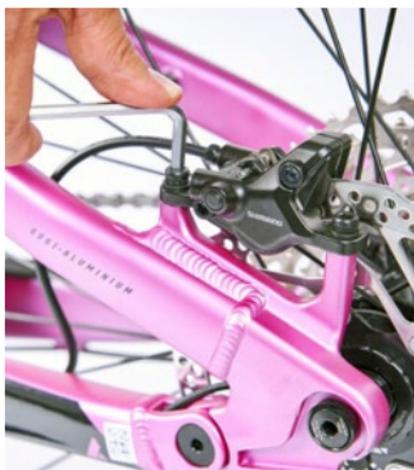
Wenn Bremsbeläge schleifen und quietschen, kann es sein, dass diese nicht exakt parallel zur Bremsscheibe sitzen; dann kann der Bremsattel dezent nachjustiert werden.
